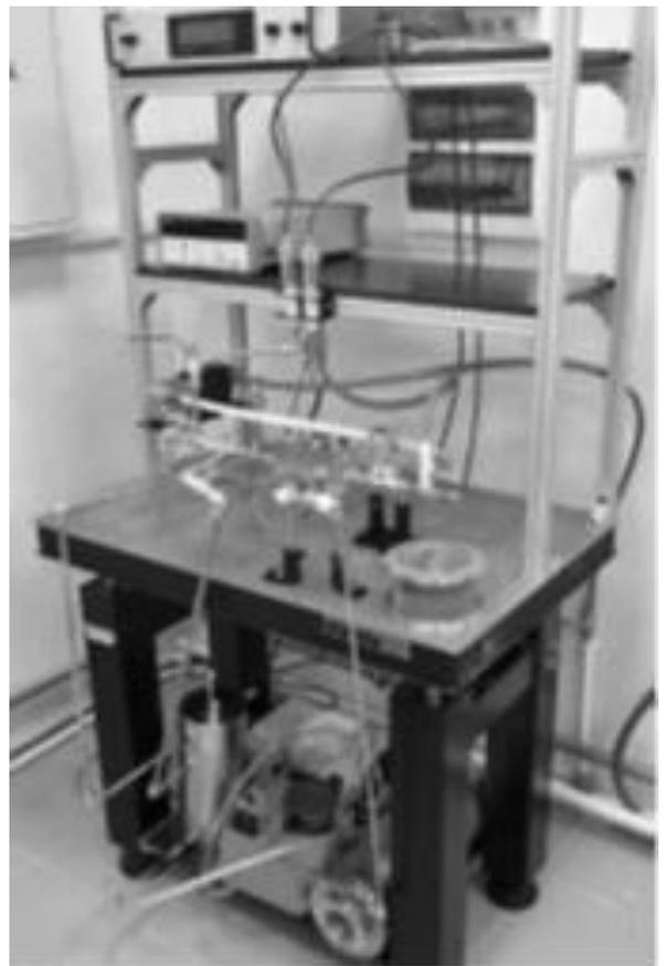
Рис. 1. Принципиальная схема (слева) и фотография (справа) опытного образца системы испарительного охлаждения: TS – испытательный участок; C – конденсатор; S – сепаратор; R – приемник; CV – регулирующий клапан; LP – жидкостный насос; CG – газовый вакуумный насос-компрессор; BWS – строительный водопровод, MP – мембранный насос.
