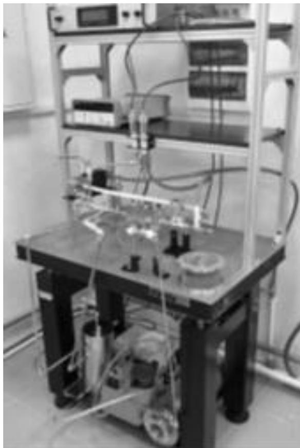
Рисунок 1. Принципиальная схема (слева) и фотография (справа) опытного образца системы испарительного охлаждения: TS – рабочий участок; C – конденсатор; S – сепаратор; R – приемник; CV – регулирующий клапан; LP – жидкостный насос; CG – газовый вакуумный насос-компрессор; BWS – водоснабжение здания.
